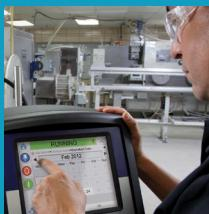
1550 和 1650 CLARiTY™ 界面以合乎逻辑的方式显示故障信息，方便您识别、聚焦于重大问题并深入分析非计划停机的根源。
